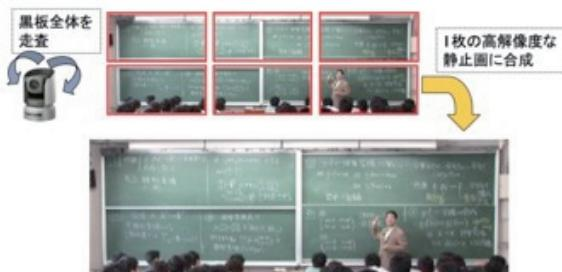
図3 走査型ハイビジョンカメラを用いた黒板群収録のイメージ図
